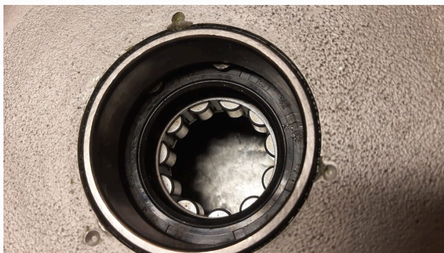
Prawy karter - zamontowane docelowe pierścienie zewnętrzne łożysk oraz uszczelniacz
