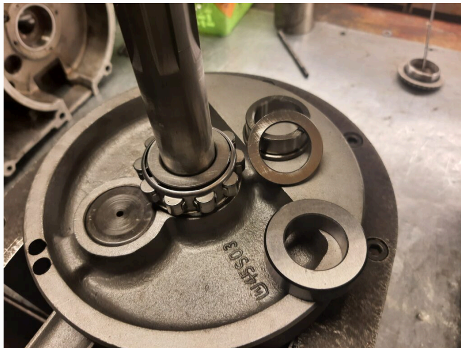
Finalny montaż łożysk
