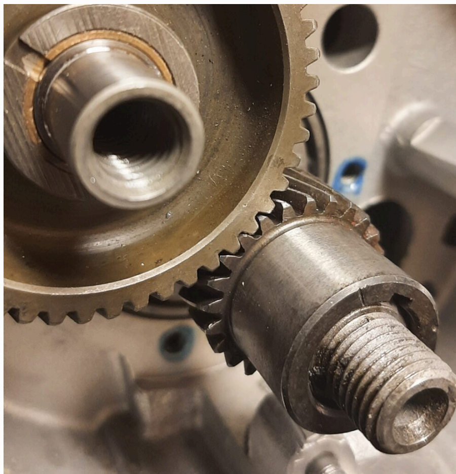
Sprawdzenie wzajemnego położenia kół rozrządu
