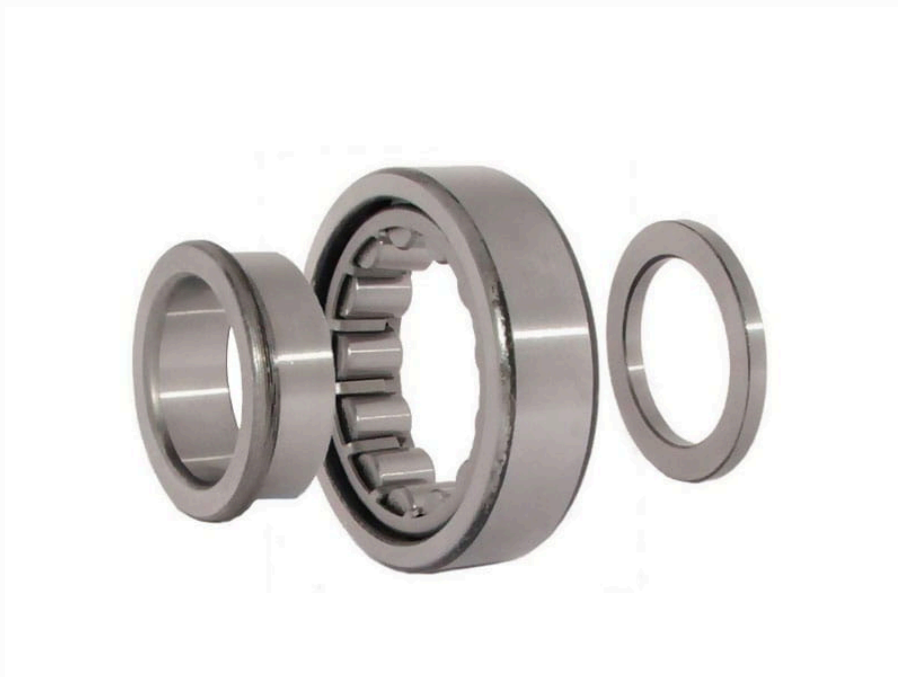
Łożysko NUP305 zastępujące łożysko NJ305 i pierścień HJ305
