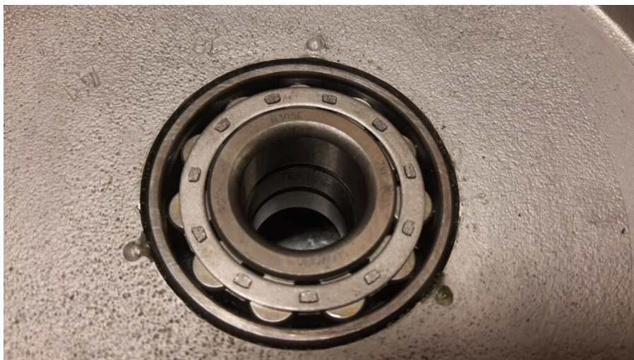
Prawy karter - sprawdzenie położenia wewnętrznego i zewnętrznego pierścienia łożyska N305
