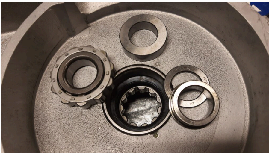
Prawy karter - docelowe wewnętrzne pierścienie łożysk oraz tuleja dystansowa
